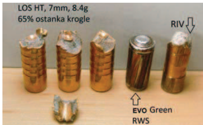
9. Tri krogle LOS HT 8,4 g po strelju; primerjava s kroglo EVO Green in RIV
