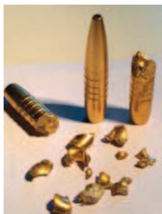
7. Krogla LOS HT 9,4 g po strelu; vidni drobci prednjega dela krogle in ostanka dveh krogel.
