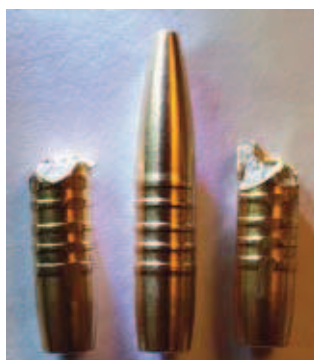
2. Krogla LOS HT po strelu; primerjava z neizstreljeno kroglo, vidni vtisi polj cevi v krogline »prstane«
