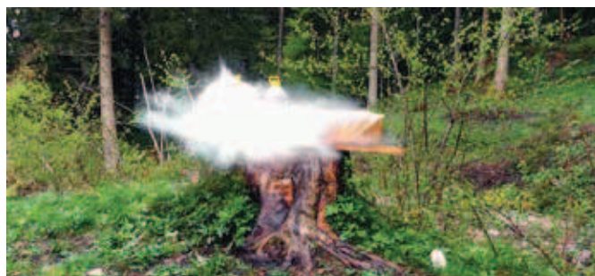
6. Trenutek ob zadetku krogle LOS v testni material, v posode z vodo in v vrečo z namočenim papirjem.
